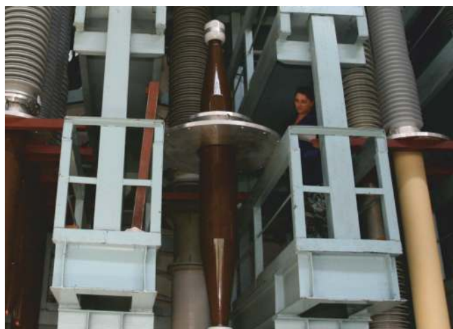
Рис. 18. Ввод «масло — элегаз» 330 кВ (в центре) в сборочном цехе завода «Изолятор»
