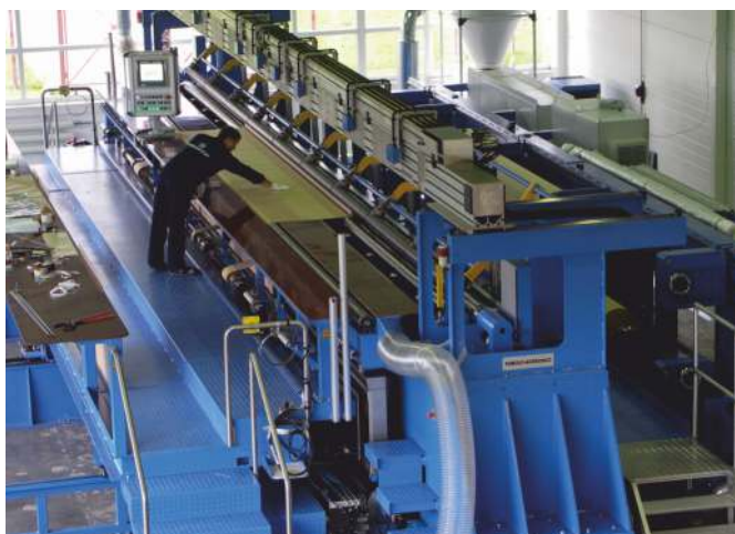
Рис. 15. Высокоавтоматизированный станок для намотки бумажной изоляции 220–1150 кВ
