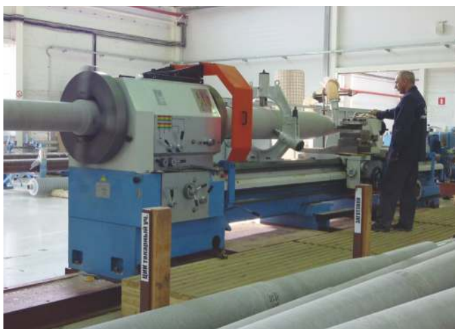
Рис. 17. Токарная обработка RIP-изоляции 500 кВ на заводе «Изолятор»
