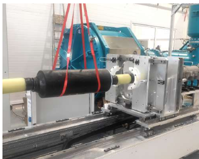
Приёмо-сдаточные испытания управляющего тела соединительной муфты на класс напряжения 220 кВ
