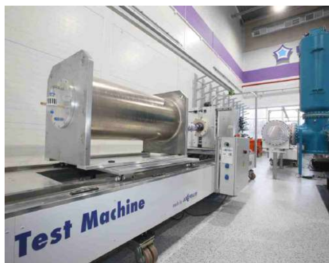
Стенд для испытаний арматуры на классы напряжения 110-500 кВ
