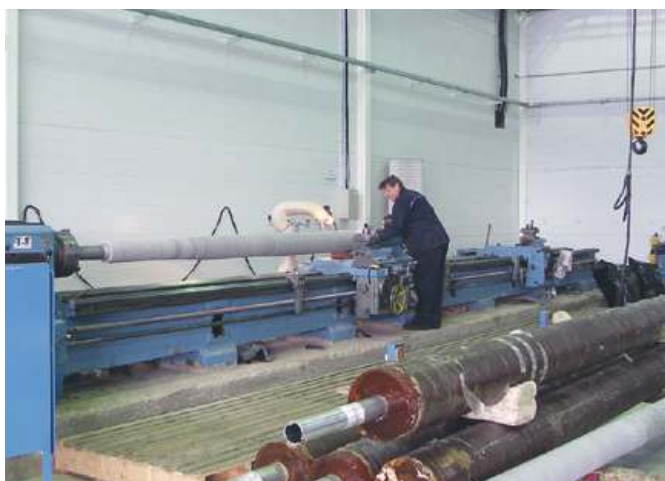
Рис. 10. Токарная обработка RIP-изоляции 220 кВ на заводе «Изолятор»
