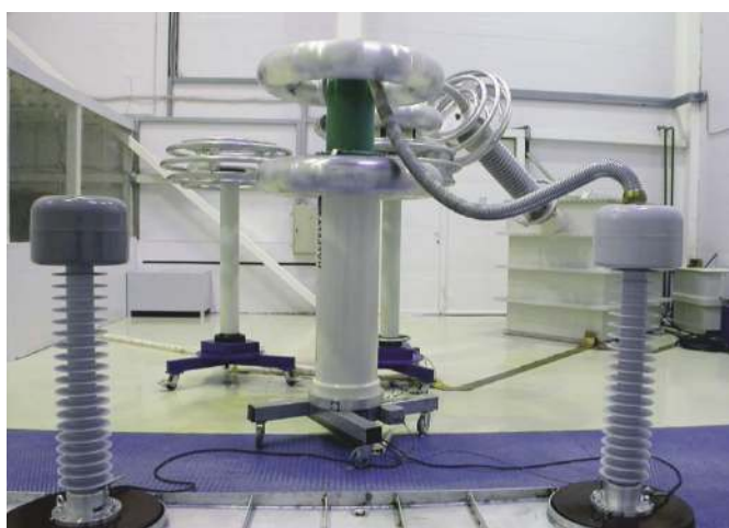
Рис. 21. Электрические испытания вводов 110 кВ на заводе «Изолятор»
