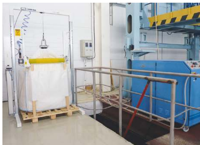
Рис. 12. Установка для дегазации и дозирования компрессионного геля на заводе «Изолятор»
