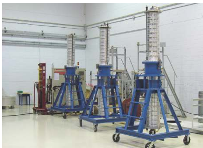
Рис. 13. Прямое литье силиконовой резины на твердую RIP-изоляцию на заводе «Изолятор»
