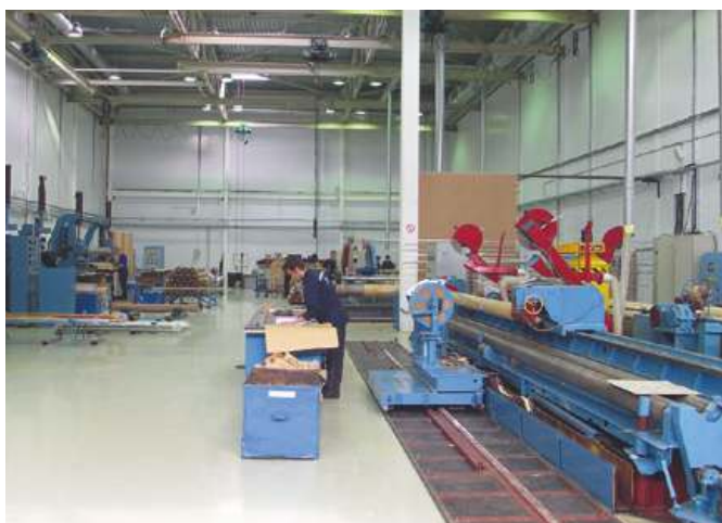
Рис. 8. Участок намотки бумажной изоляции 35–750 кВ на заводе «Изолятор»
