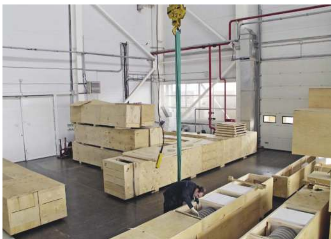
Рис. 22. Упаковка вводов на заводе «Изолятор»
