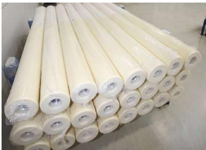
Рис.17. Изоляционные остова 110 кВ, изготовленные по RIN-технологии и подготовленные для сборки высоковольтных вводов
