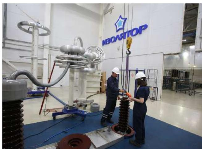
Рис. 21. Испытания вводов на класс напряжения 110 кВ
