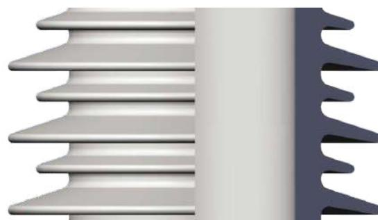
Рис. 4. Профиль фарфоровой покрывки
