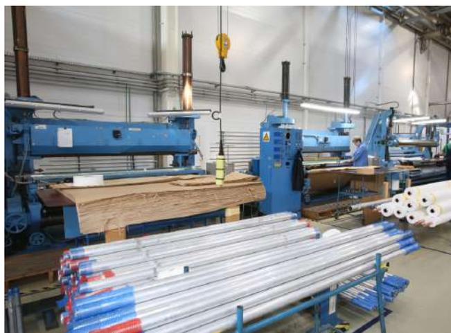
Рис.14. Станки для намотки основной изоляции вводов классов напряжения от 10 до 150 кВ
