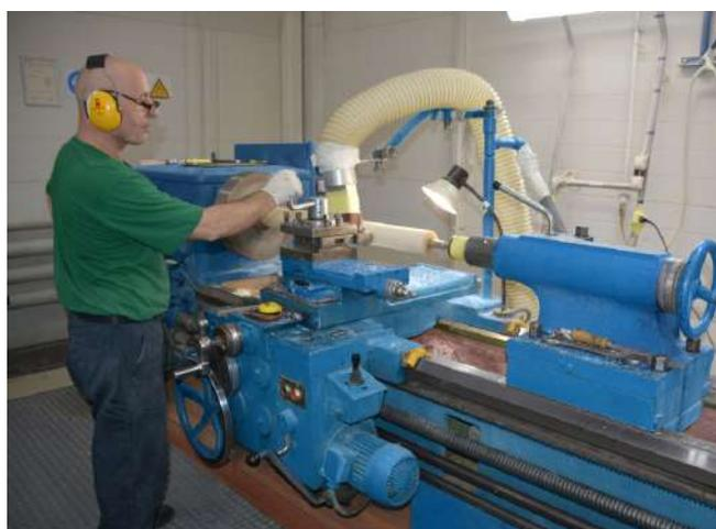
Рис.16. Механическая обработка изоляционного остова ввода класса напряжения 35 кВ
