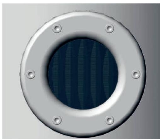
Рис. 7. Нормальный уровень жидкого наполнителя
