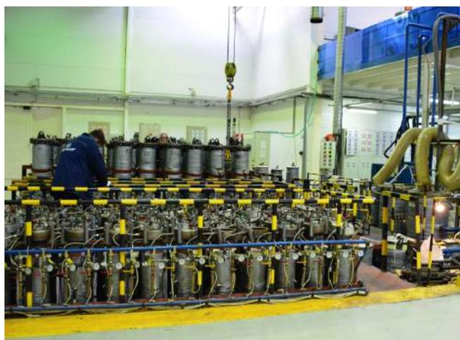
Рис.15. Вакуумная пропитка электроизоляционным компаундом и полимеризация под давлением внутренней изоляции вводов классов напряжения от 35 до 150 кВ
