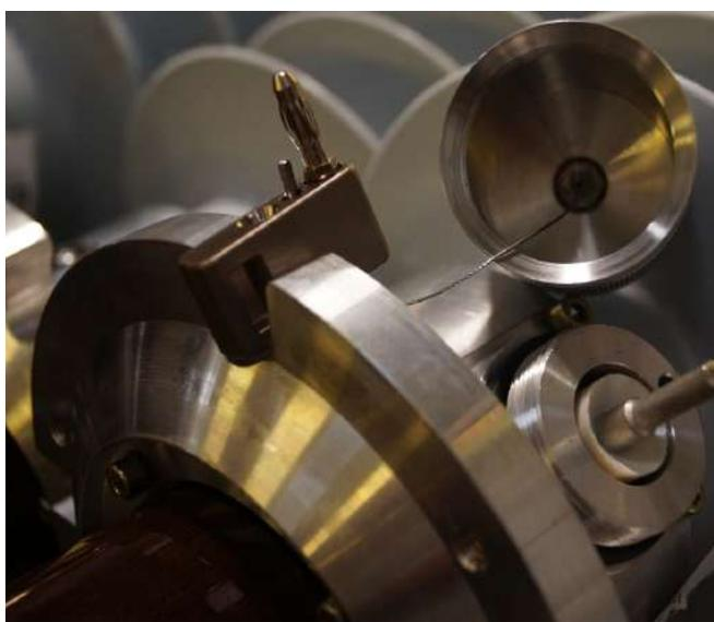
Рис.13б. Измерительный вывод со снятым колпаком
