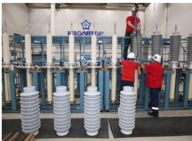
Рис.18. Сборка вводов с фарфоровой внешней изоляцией класса напряжения 110 кВ для масляных выключателей
