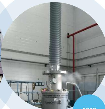
Впервые в России в Производственном комплексе «Изолятор» были успешно испытаны высоковольтные вводы, помещенные в криостат с жидким азотом. Специально разработанные вводы классов напряжения 110 и 220 кВ с RIN-изоляцией и емкостным регулированием электрического поля выдержали перепад температур от  $-200^{\circ}\text{C}$  в нижней части до  $+10^{\circ}\text{C}$  в верхней точке.
