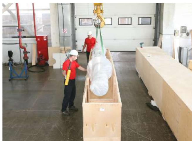
Рис. 22. Упаковка изготовленных и испытанных высоковольтных вводов перед отгрузкой заказчику
