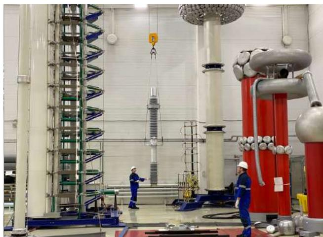
Рис. 20. Испытания ввода класса напряжения 220 кВ для масляных выключателей
