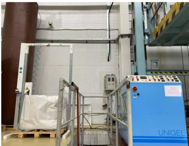
Рис.22 Установка для дегазации и дозирования компрессионного геля
