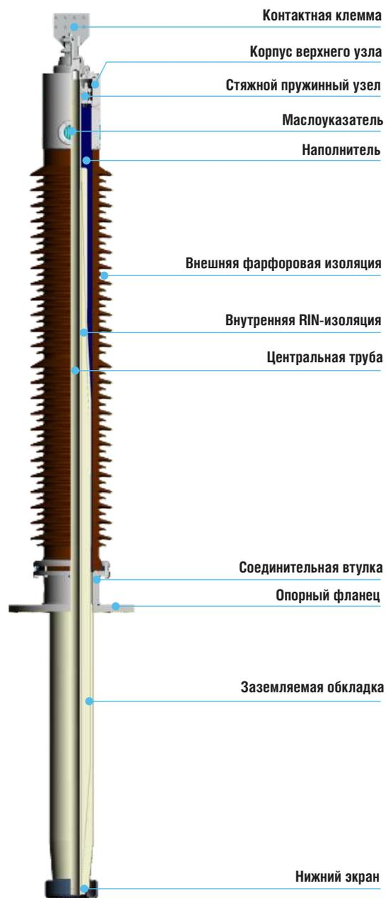
Рис.1 Ввод с фарфоровой внешней изоляцией
