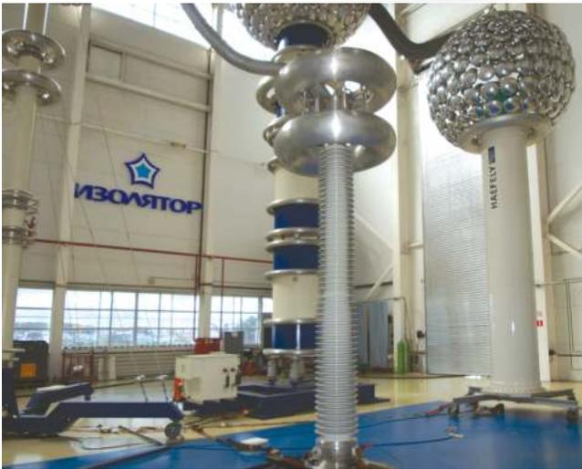
**Рис.24** Электрические испытания ввода 500 кВ с RIN-изоляцией в испытательном центре «Изолятор»
