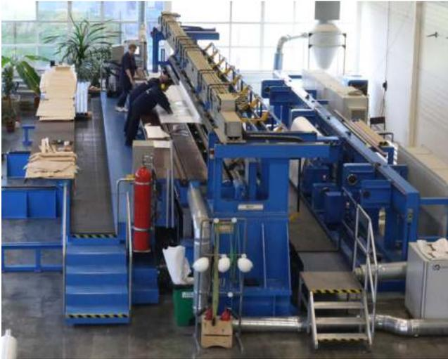
**Рис.18** Высокоавтоматизированный станок для намотки основной изоляции 220–1150 кВ
