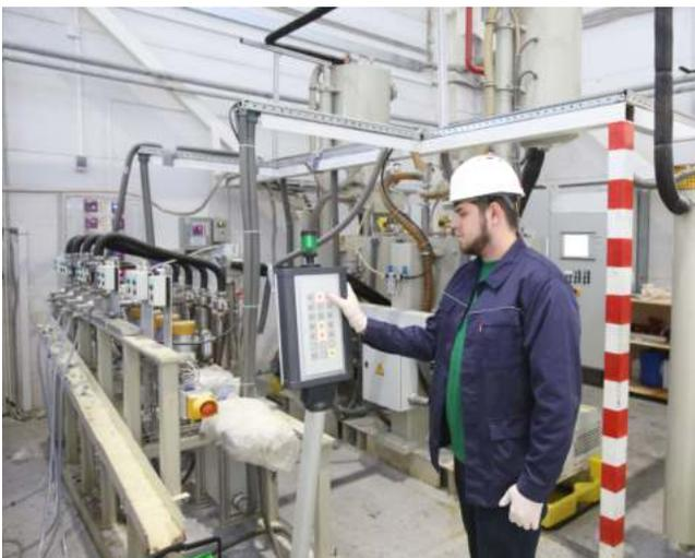
**Рис.19** Вакуумная пропитка основной изоляции
