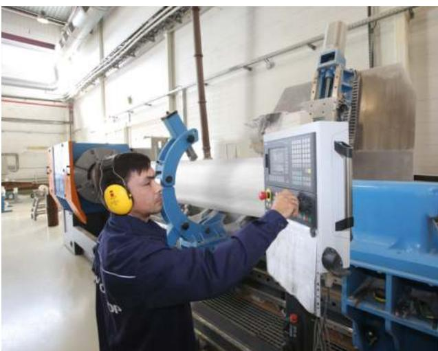
**Рис.20** Токарная обработка изоляционного остова
