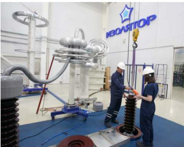
**Рис.25** Электрические испытания вводов 110 кВ
