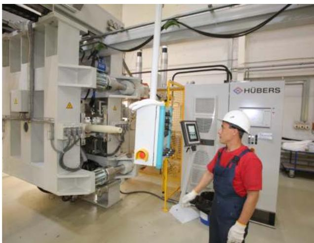
Рис.23 Автоматическое изготовление внешней полимерной изоляции
