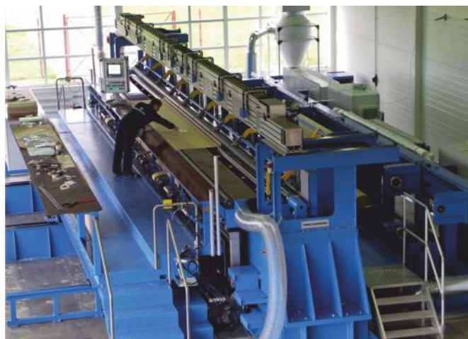
Рис. 18. Высокоавтоматизированный станок для намотки основной изоляции 252–1200 кВ
