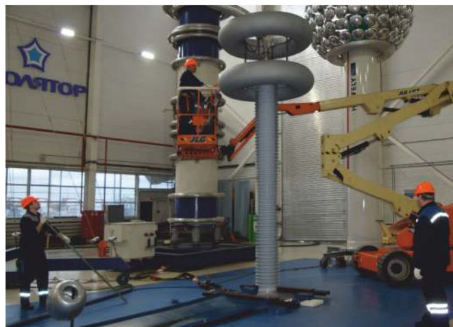
Рис. 24. Участок испытаний вводов 252–1200 кВ
