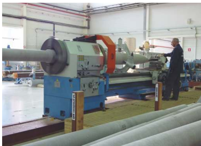
Рис. 20. Токарная обработка RIP-изоляции 550 кВ
