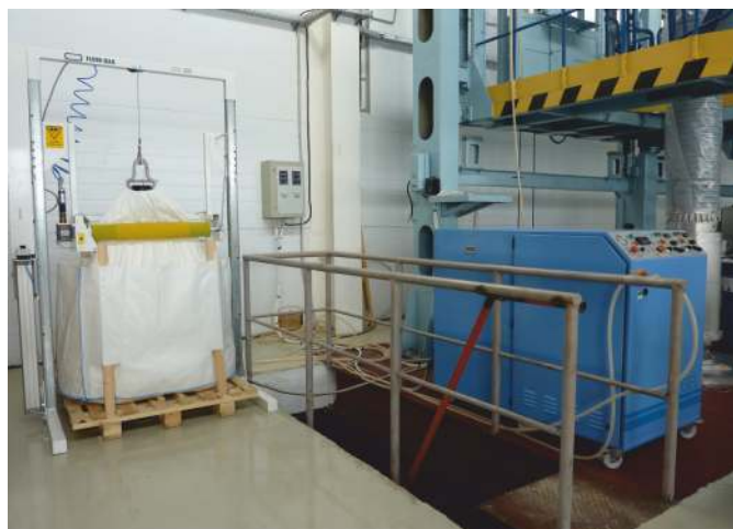
Рис. 22. Установка для дегазации и дозирования компрессионного геля
