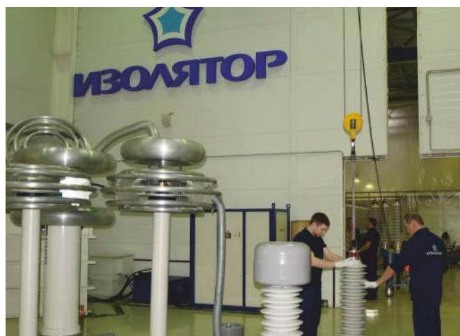
Рис. 25. Электрические испытания вводов 126 кВ
