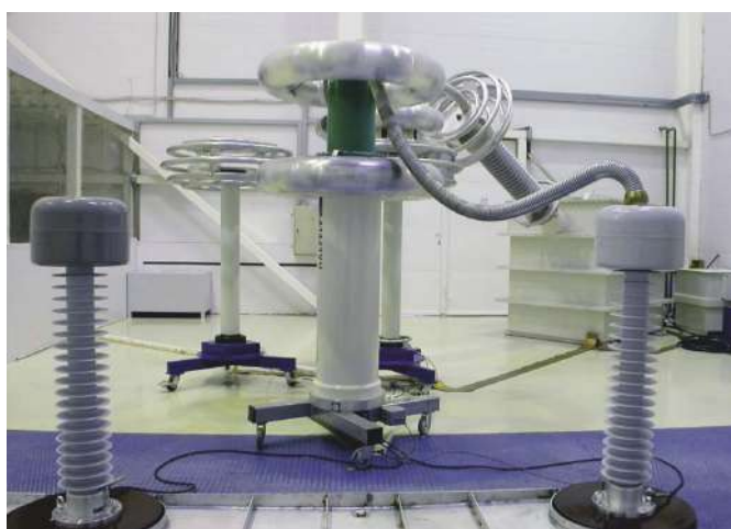
Рис. 21. Электрические испытания вводов 110 кВ на заводе «Изолятор»
