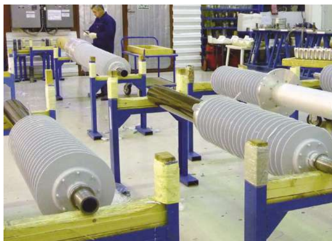
Рис.19. Подготовка к контролю качества полимерной изоляции
