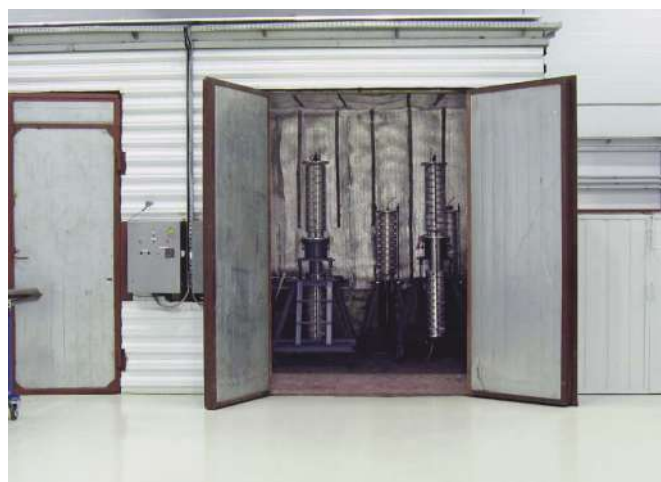
Рис.18. Тепловое отверждение полимерной изоляции
