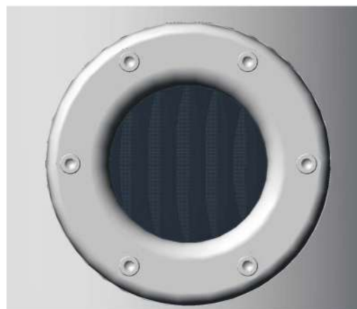
Рис. 7. Нормальный уровень жидкого наполнителя
