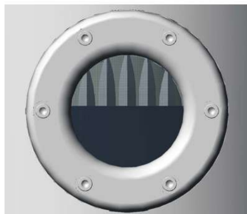
Рис. 8. Пониженный уровень жидкого наполнителя
