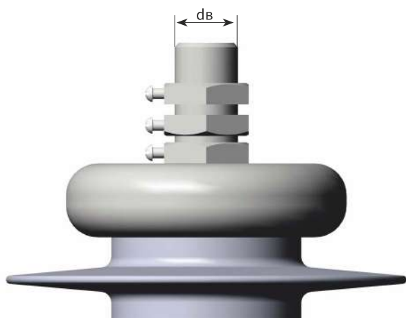
Рис. 11. Контактная шпилька ввода 35 кВ
