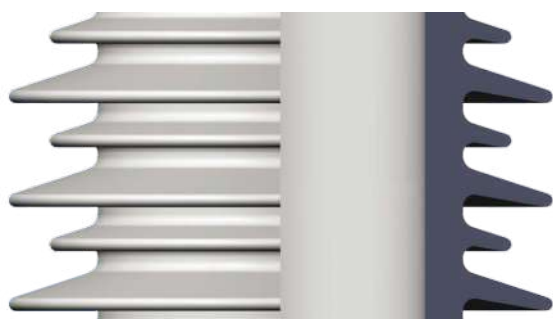
Рис. 4. Профиль фарфоровой покрывки
