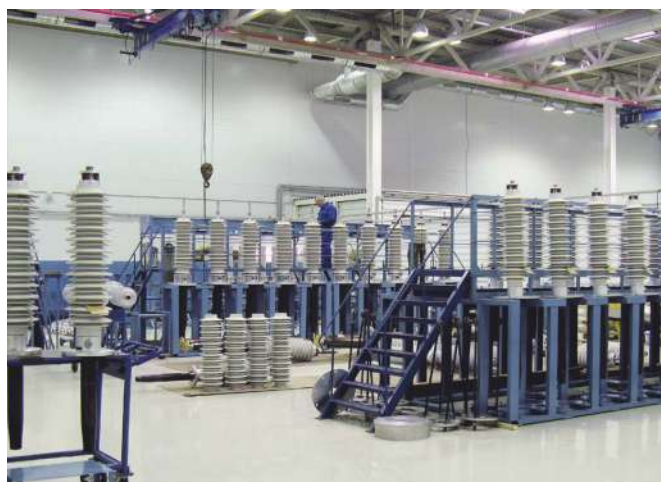
Рис.17. Сборка вводов 110 кВ с фарфоровой внешней изоляцией
