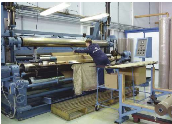
Рис.14. Намотка бумажной изоляции 110 кВ широким полотном
