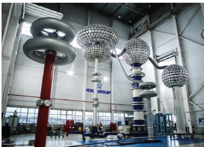
Рис. 20. Станция для испытаний вводов классов напряжения от 220 до 1150 кВ
