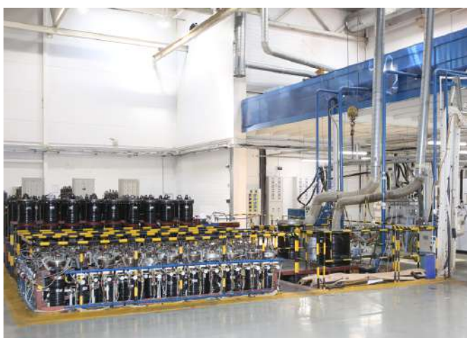
Рис. 9. Вакуумная пропитка электроизоляционным компаундом и полимеризация под давлением внутренней изоляции вводов
