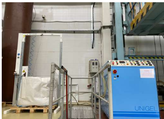
Рис. 12. Установка для дегазации и дозирования компрессионного геля
