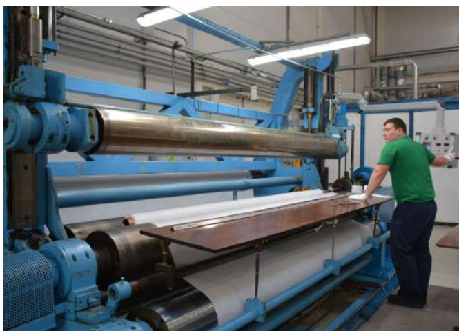
Рис. 8. Намотка внутренней RIN-изоляции
