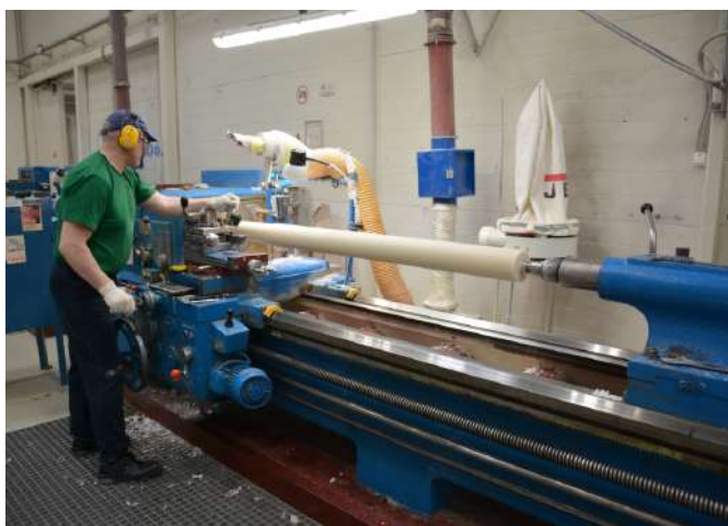
Рис. 10. Механическая обработка изоляционного остова ввода
