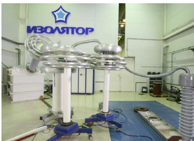
Рис. 21. Станция для испытаний вводов классов напряжения от 10 до 150 кВ
